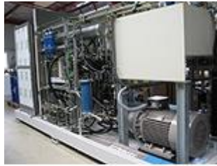
Abb.: Hydraulischer Prüfstand für Pumpen und Motoren mit Energierückgewinnung im Aufbau
