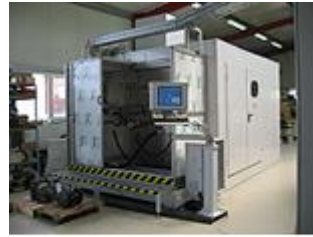
Abb.: Pumpen- und Motorenprüfstand vorbereitet für die Werkabnahme
